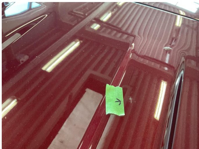
1.6 Lakkblære med hull/sprekk
