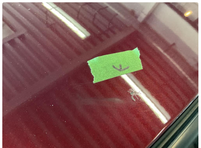
1.6 Lakkblære med hull/sprekk
