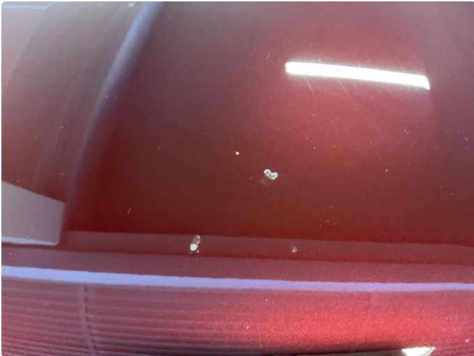
1.1 Stygge flekker på panser
