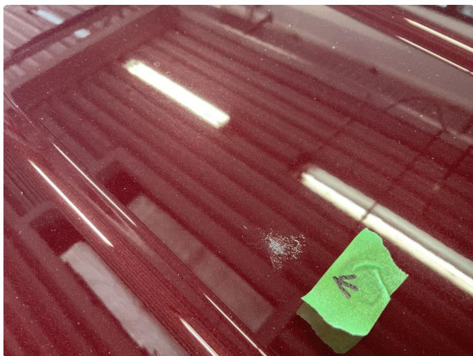
1.6 Lakkblære med hull/sprekk
