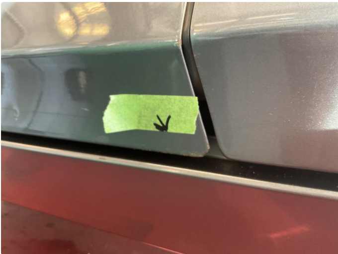
1.3 Nå begynt rust på begge for dører
