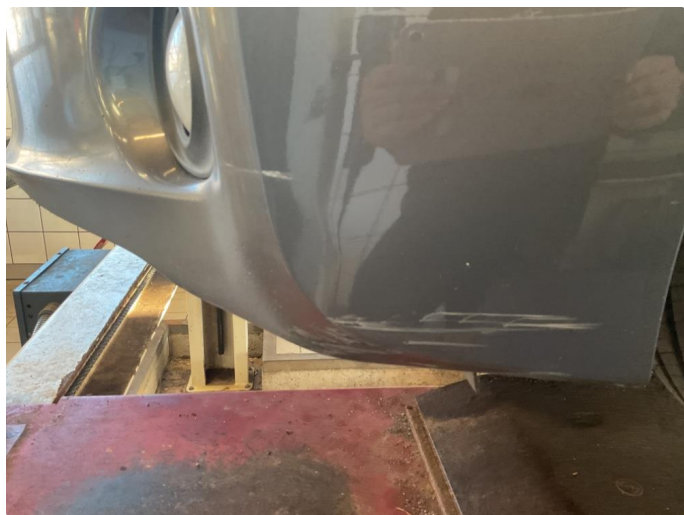
1.9 Mye steinsprut på fanger foran og riper Sluket fanger under skilt ramme og sprukket feste til skilt ramme
