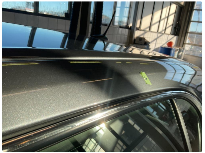
1.13 V.side liten bulk opp ved tak
