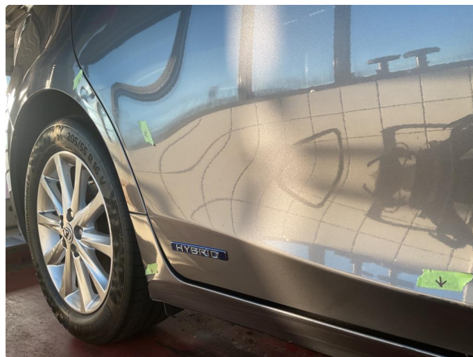
1.5 Riper og liten bulk h bak dør
