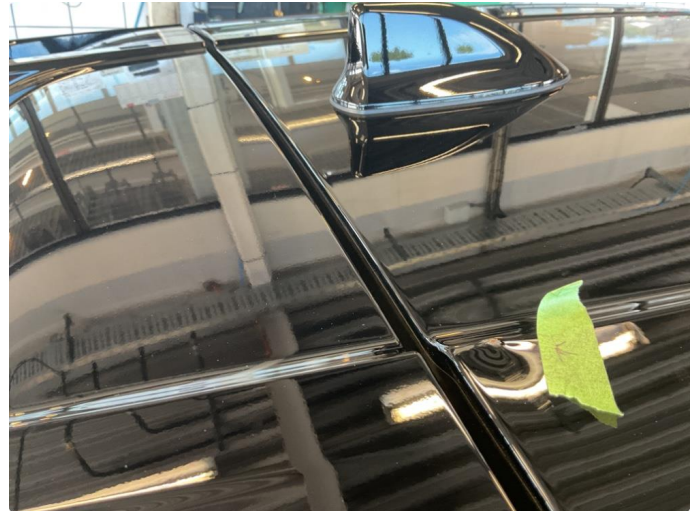
1.1 Liten bulk h side og bak Noe Stein sprut på tak
