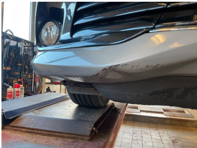
1.3 Ripe(r) ned til grunning
