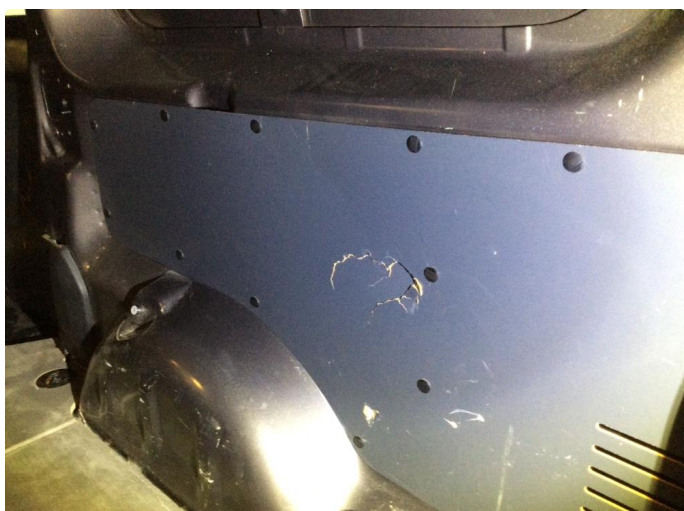
2.1 Skadet/merker etter utstyr
