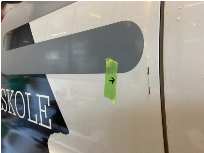
1.1 Bulk med lakk skade fører dør
