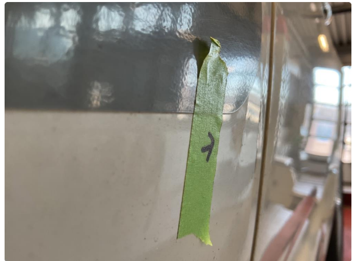
1.1 Bulk med lakk skade fører dør
