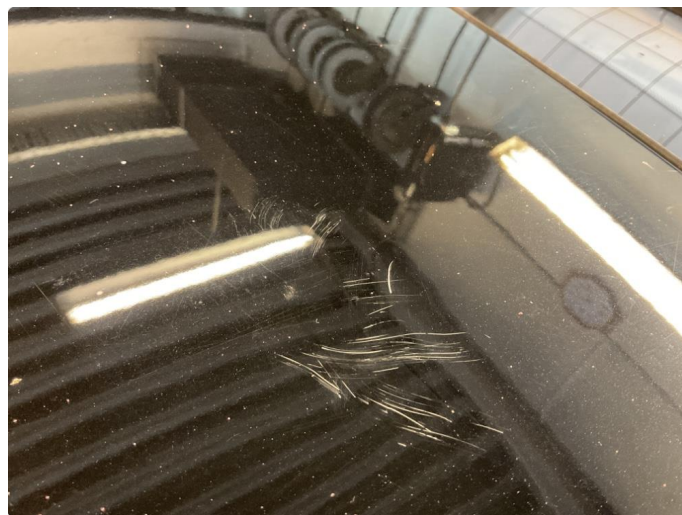
1.8 Riper i lakken på tak og noen små bulker
