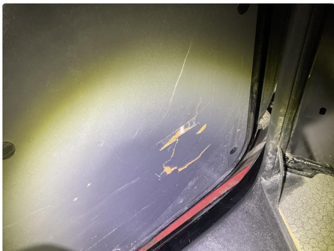
2.1 Skade på deksler i varerom
