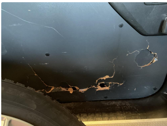
2.1 Skade på deksler i varerom
