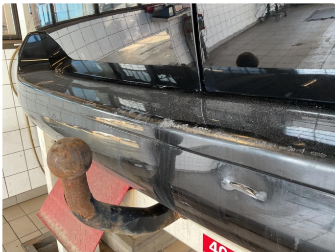
1.7 Skade i fanger bak og endel bruks merker
