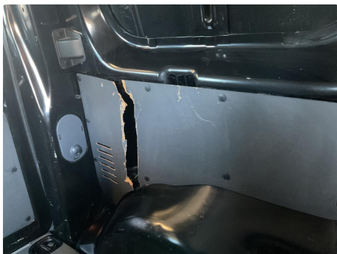
2.1 Skade på deksler i varerom
