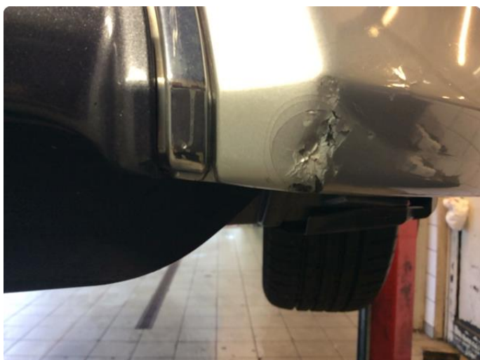
1.4 Skade på fanger foran v side og på midtten
