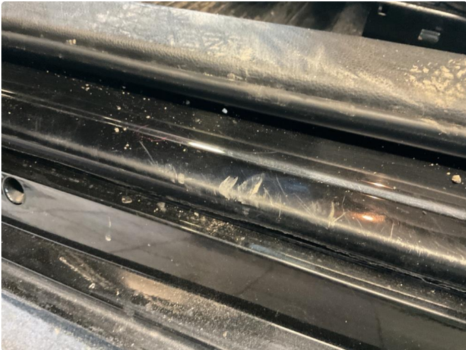
1.1 Slitt innsteg fører dør
