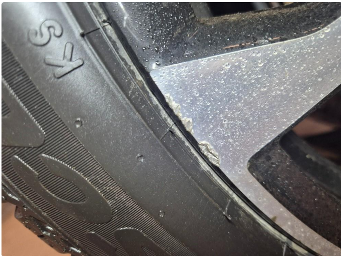
1.1 Liten kantkjøring 1 felg.
