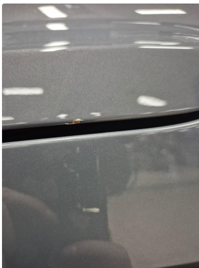
1.2 Liten steinsprut bakluke, lagt i lakk.
