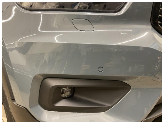
1.1 Noen riper og småbulker
