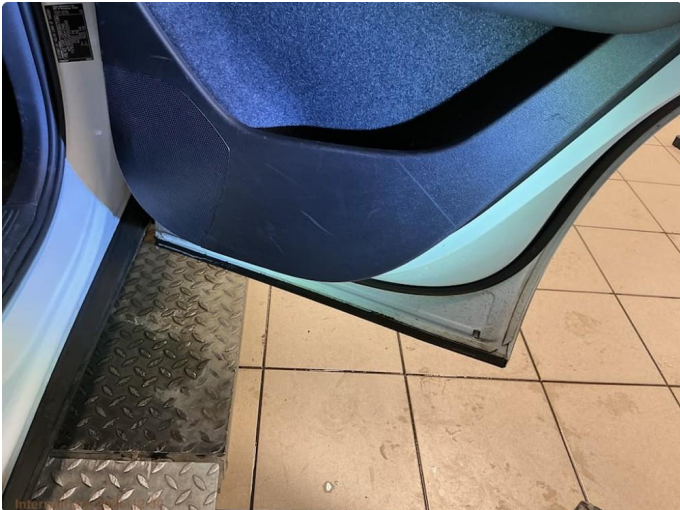
2.1 Normal slitasje dørtrekk etter inn/ut-stigning
