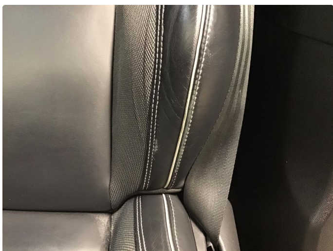
2.1 Liten slitasje på sidestøtter
