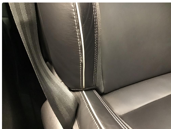
2.1 Liten slitasje på sidestøtter
