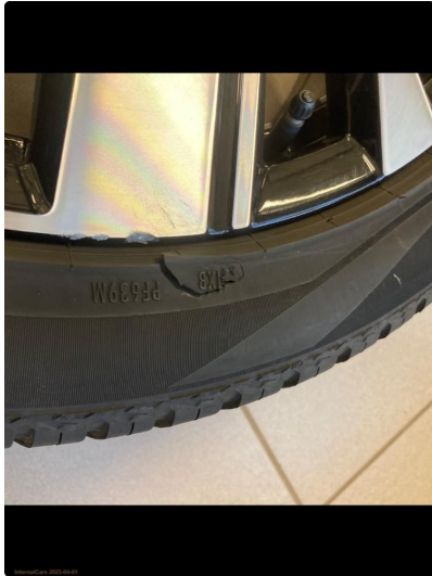
1.1 Lite hakk i sommerfelg. Dekket er byttet
