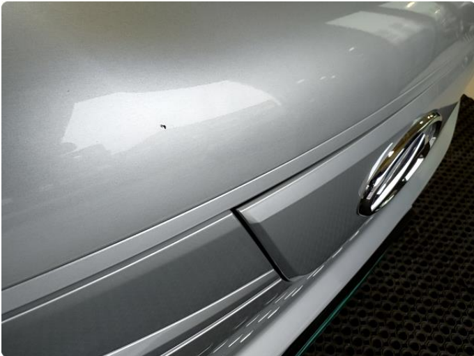
1.1 Steinsprut på plastposer- ruster ikke
