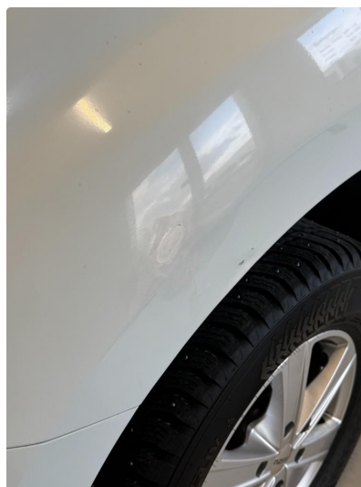
1.4 Rust - pusset og grunnet+lakkert
