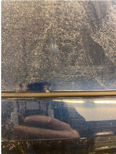
1.1 Noe steinsprut med rust
