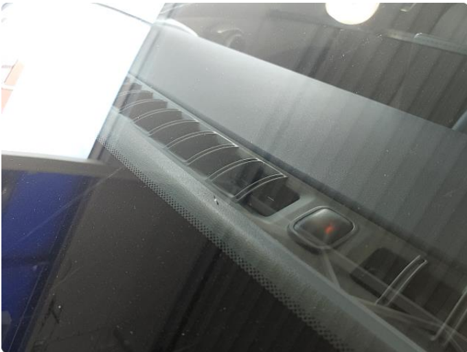
1.1 Steinsprutsprut. Tettes før overlevering.
