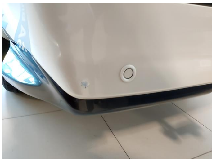
1.3 Lite skrap begge sider i plastfanger bak
