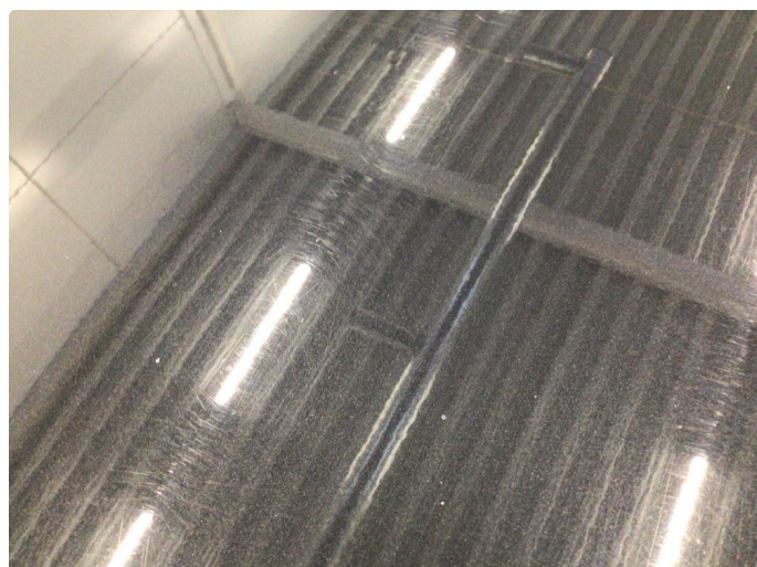
1.1 Steinsprut, blir fleklakkert
