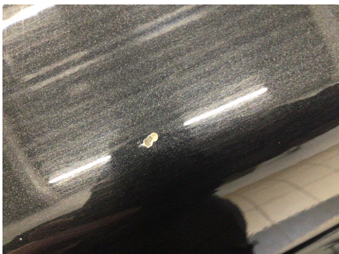
1.1 Steinsprut, blir fleklakkert
