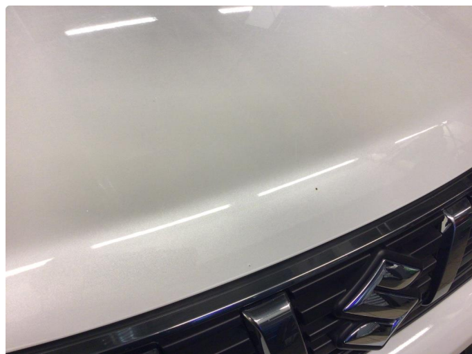
1.1 Noe steinsprut med rust
