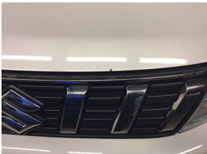
1.1 Noe steinsprut med rust
