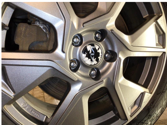
1.1 Hjul kapsel skadet
