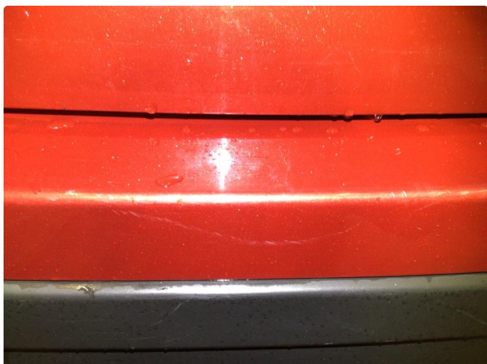
1.1 Noen riper og småbulker
