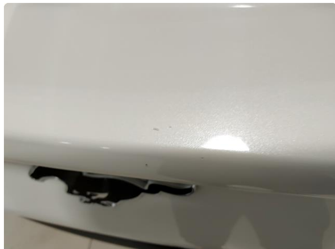
1.2 Små sår/hakk midt på bakluke. Ikke igjennom lakk
