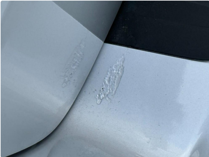
1.1 Tidligere behandlet rustdannelse
