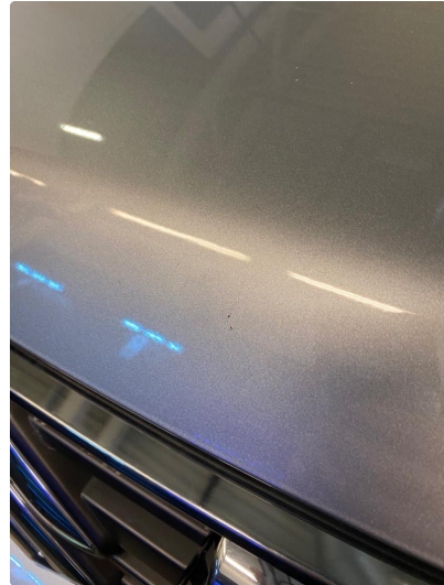
1.1 Noe steinsprut med rust
