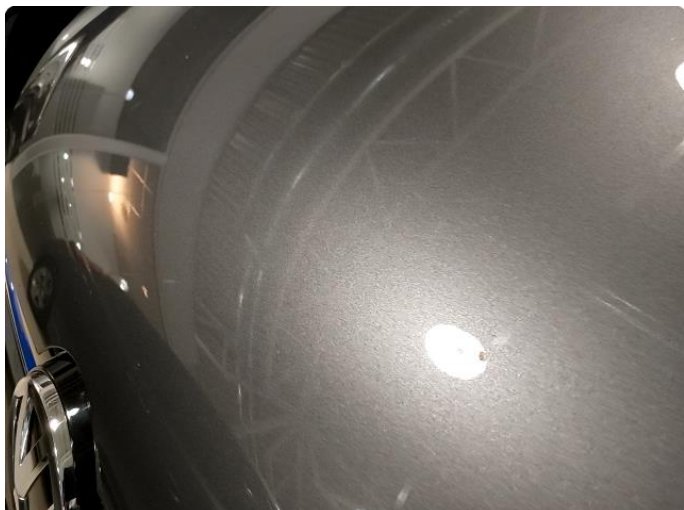
1.1 Smått med steinsprut på panser
