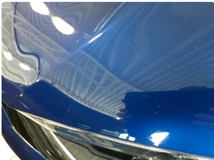
1.1 Smått med steinsprut- normal slitasje
