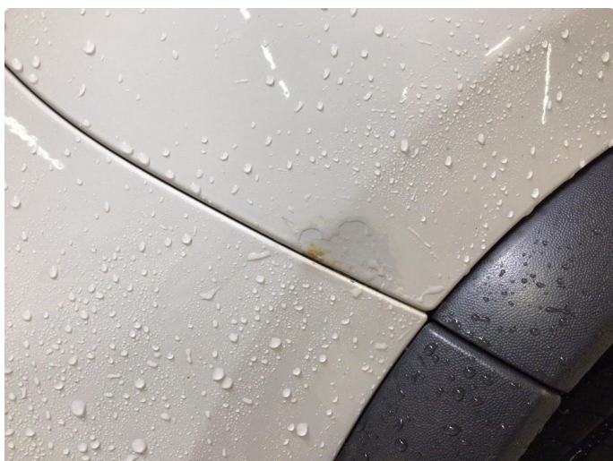
1.3 Grunnet - Dårlig lakket
