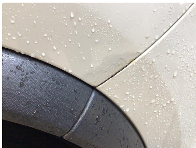
1.3 Grunnet - Dårlig lakket
