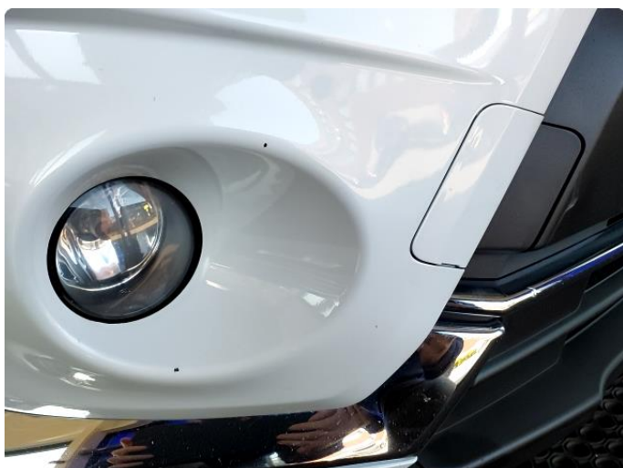
1.2 Litt Steinsprut I plastfangeren foran
