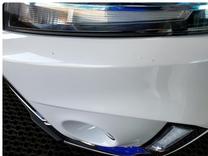
1.2 Litt Steinsprut I plastfangeren foran
