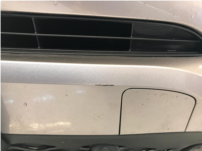
1.1 Steinsprutskade, kan pensles. Ingen rust.
