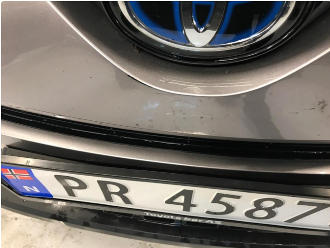
1.1 Steinsprutskade, kan pensles. Ingen rust.
