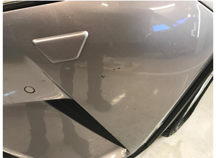
1.1 Steinsprutskade, kan pensles. Ingen rust.
