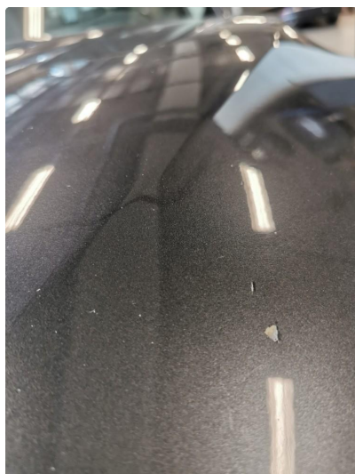
1.1 Noe steinsprut som kan flekkes
