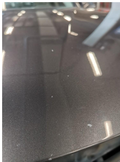
1.1 Noe steinsprut som kan flekkes
