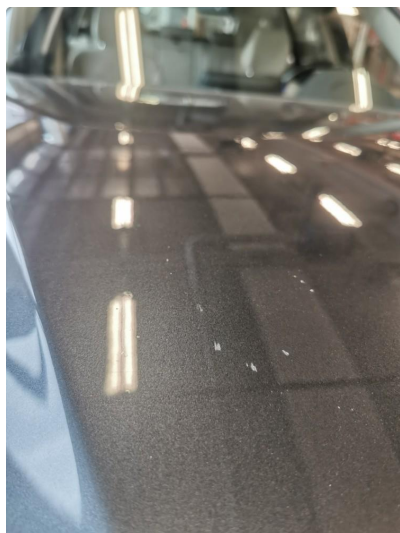
1.1 Noe steinsprut som kan flekkes
