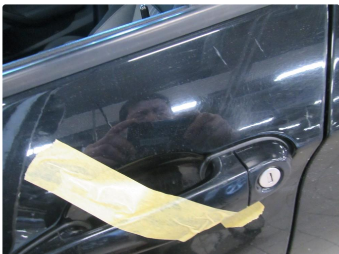
1.1 Endel riper og skrammer, noe kan poleres vekk
