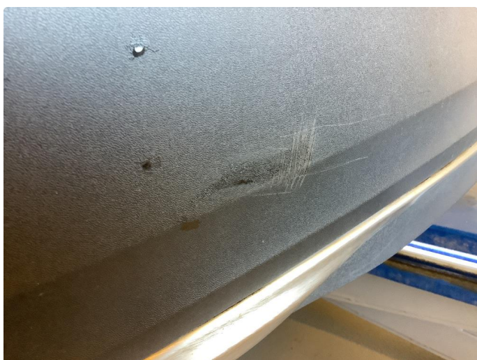
1.3 Liten grov stripe i svart plast nedre del fanger bak venstre side.
