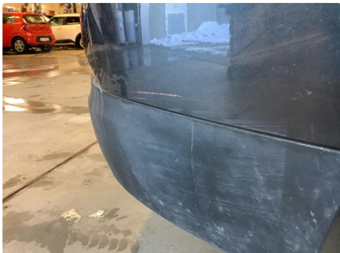
1.1 Liten sprekk i nedre svart list høyre side på støtfanger bak Div striper i støtfanger bak ved regnummer.
