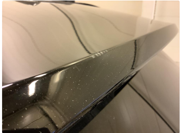
1.2 Ripe(r) ned til grunning, utført flekkklakking ok.
