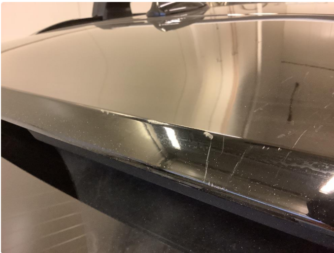
1.2 Ripe(r) ned til grunning, utført flekkklakking ok.
