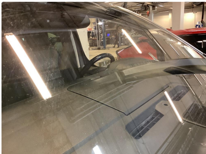
1.1 Frontrute lien steinsprang reparert ok
