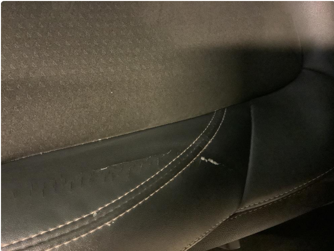
1.1 Skade på setetrekk venstre side fram, prøvd reparert.
