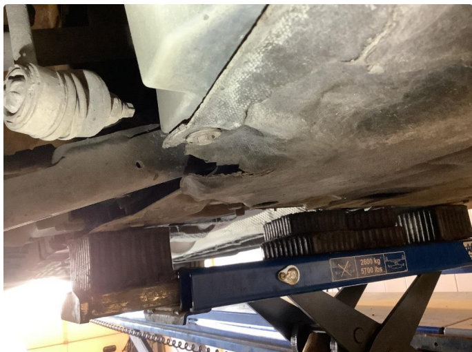
1.1 Beskyttelsesplate under motor liten skade
