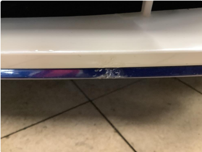
1.2 Oppriperet støtfanger foran
