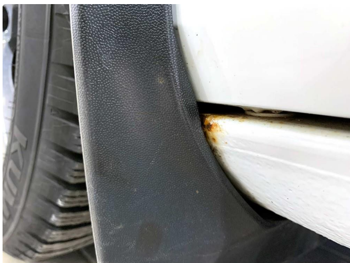
1.3 Noe lakkslitasje med overflaterust på kanal venstre foran. Normalt iht bilens alder.
