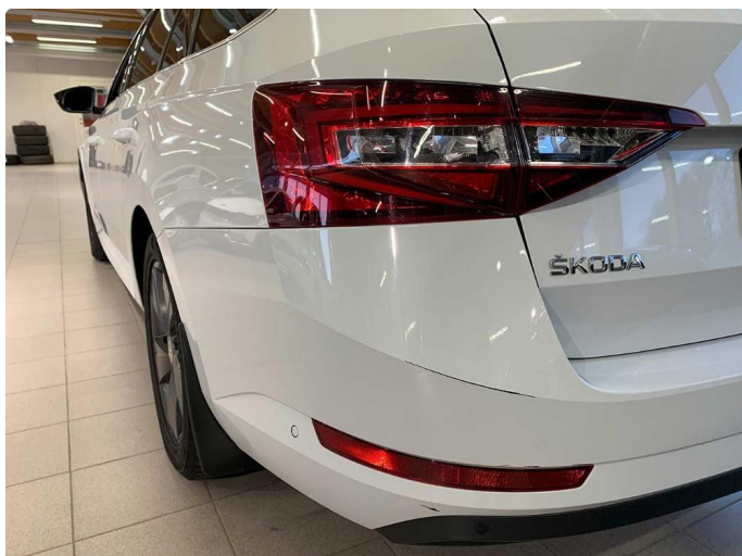
1.1 Mangler noe lakk på profil i støtfanger venstre side bak og litt under refleks i støtfanger samme side. Normal slitasje iht bilens alder.
