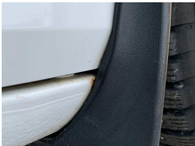
1.4 Noe lakkslitasje med overflaterust på kanal høyre foran. Normalt iht bilens alder.
