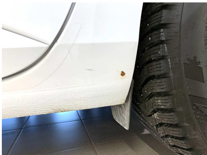
1.2 Liten lakkskade med overflaterust i kanal venstre bak. Normal slitasje iht bilens alder.
