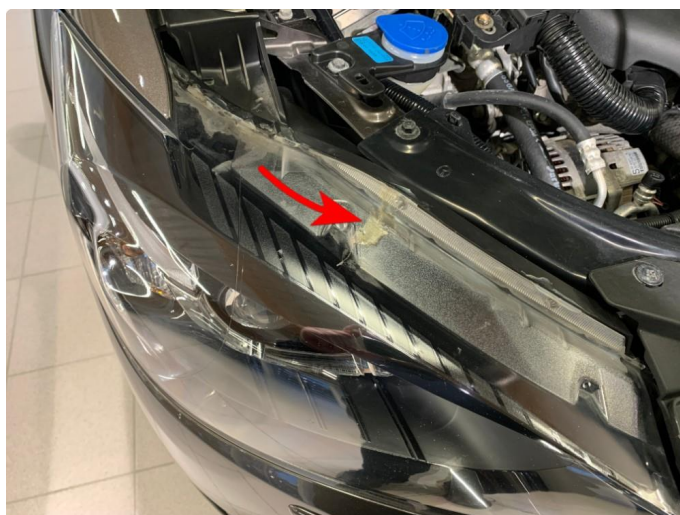
2.1 Liten sprekk i lykteglass høyre foran (utenfor lysbildet, ikke synlig ved panser lukket, er limt). Normal tilstand i henhold til bilens alder.
