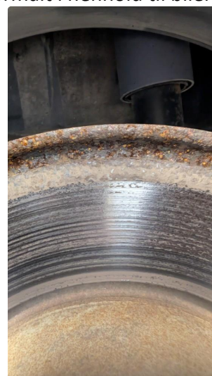
4.1 Noe rust på bremseskiver bak, men godt innenfor krav.
