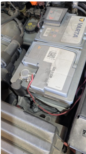
2.1 Mangler klamring på ledninger ved batteri.
