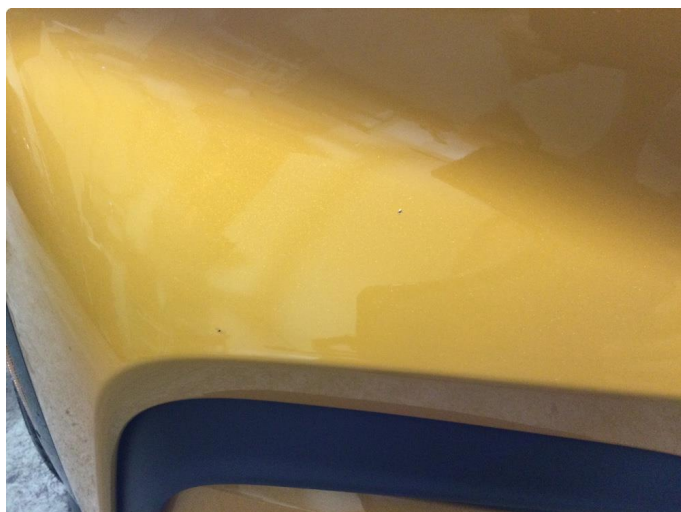
1.1 Noen få steinsprut
