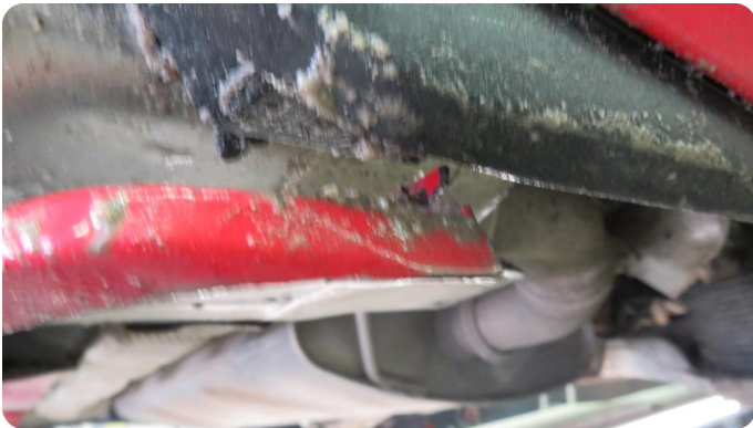
1.1 Øvrige feil Løst deksel under eksospotta
