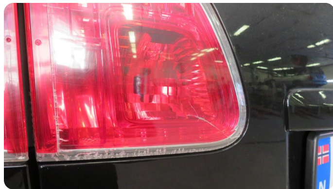
2.1 Defekt / sprukket glass Sprukket baklamper indre begge sider
