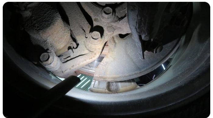
2.1 Rust Rust på skivene på hs både forran og bak
