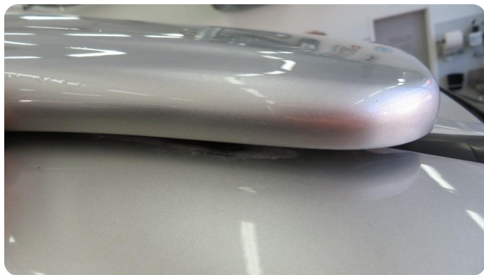
1.5 Skade Slitt gjennom lakk mellom hardtopp og tak.
