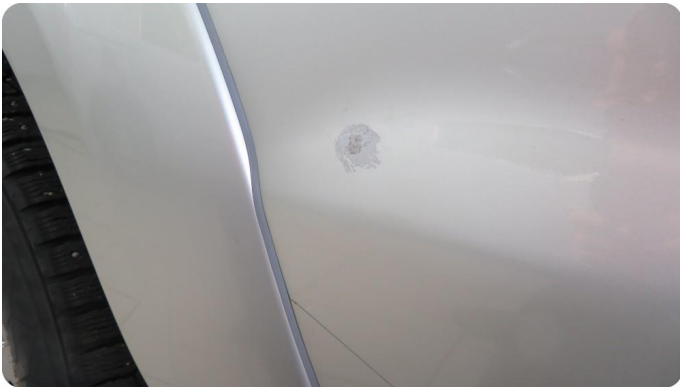
1.1 Noen bulker med lakkskader Noen bulker me lakkskade rundt om
