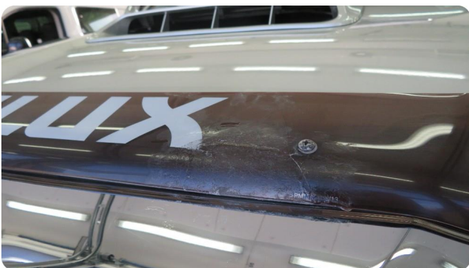
1.2 Øvrige feil Sprekk i panserbeskytter.
