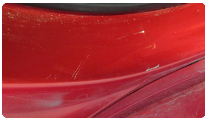
1.6 Bulk(er) med lakkskade 2 bulker og noen dype riper.
