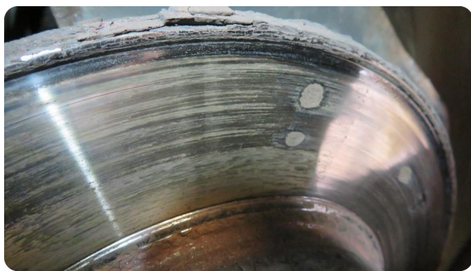
3.1 Mer enn 25% rust
