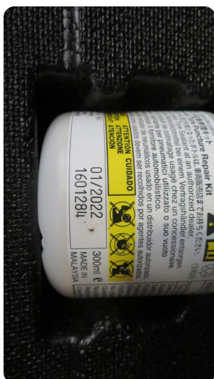
1.3 Dekktettemiddel utgått/mangler Utgått Januar 2022.
